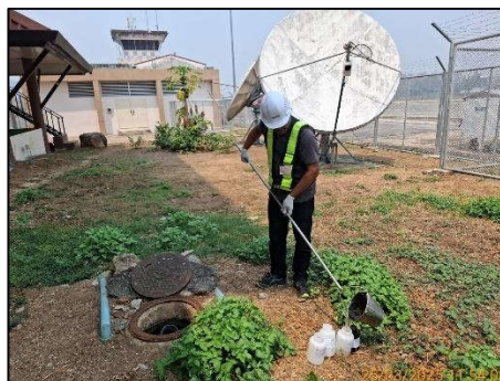
บ่อกักน้ำหลังผ่านระบบบำบัดน้ำเสียของอาคารหอบังคับการบิน
