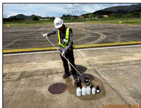
บ่อกักน้ำหลังผ่านระบบบำบัดน้ำเสียของอาคารผู้โดยสารขาเข้า ชุดที่ 3
